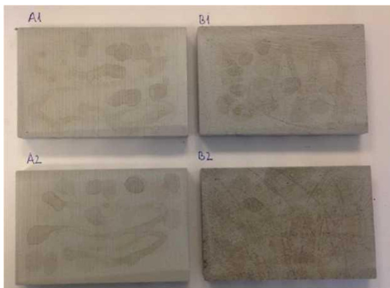
Fot. 5. Skamol Skamotec 225, brak wzrostu na powierzchni po 7 tygodniach ekspozycji
