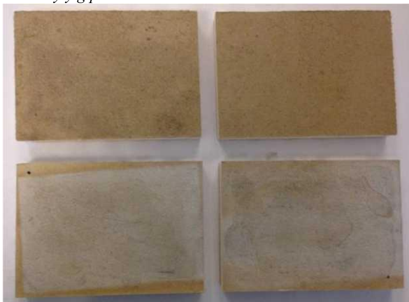
Fot. 7. Płyty gipsowe, rozwój na powierzchniach po 7 tygodniach ekspozycji
