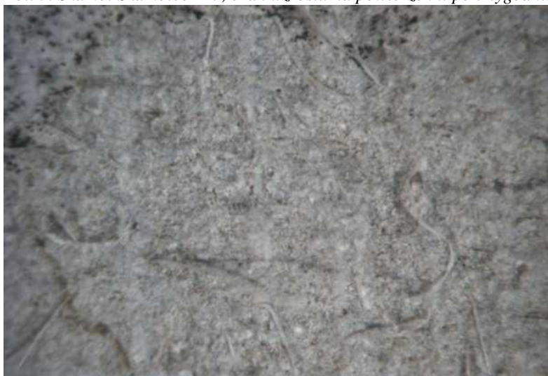
Fot. 6. Skamol Skamotec 225, brak wzrostu obserwowany przez mikroskop.
